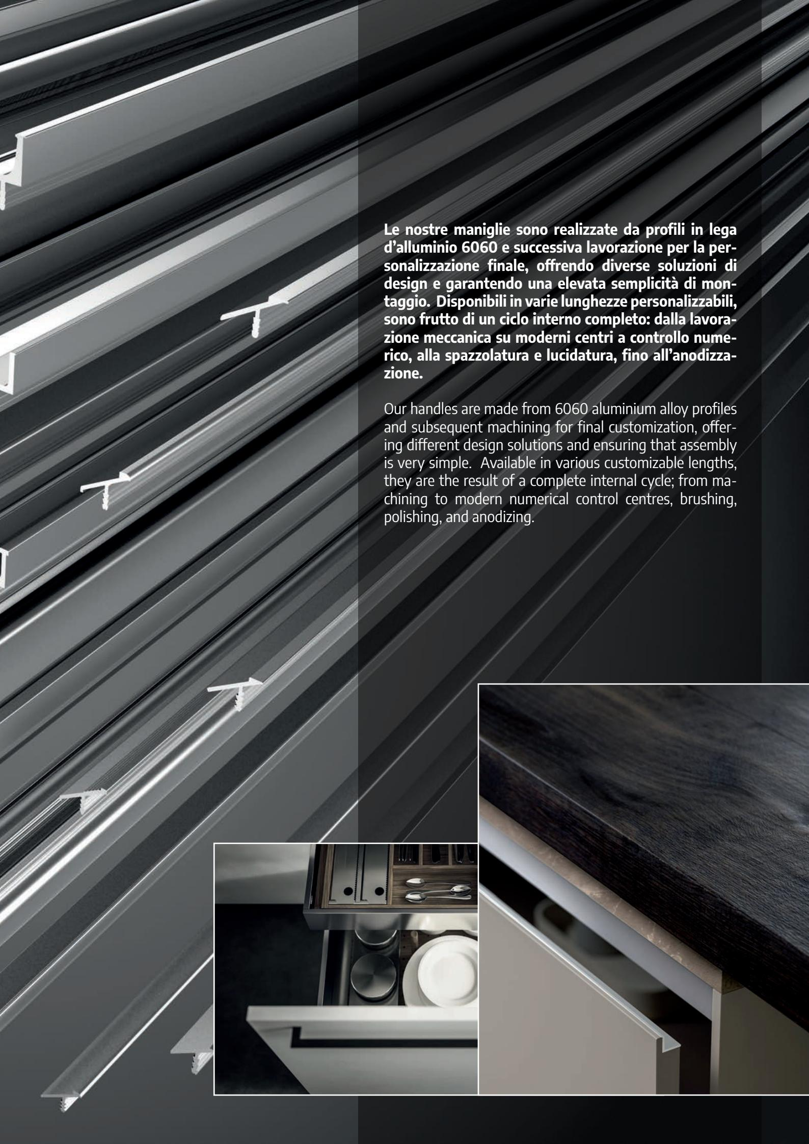
**Le nostre maniglie sono realizzate da profili in lega d'alluminio 6060 e successiva lavorazione per la personalizzazione finale, offrendo diverse soluzioni di design e garantendo una elevata semplicità di montaggio. Disponibili in varie lunghezze personalizzabili, sono frutto di un ciclo interno completo: dalla lavorazione meccanica su moderni centri a controllo numerico, alla spazzolatura e lucidatura, fino all'anodizzazione.**
