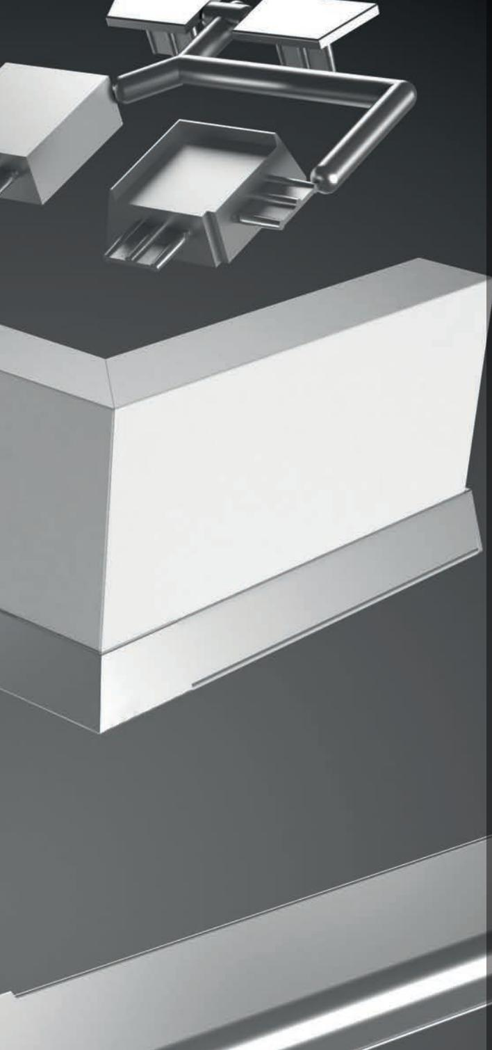
**Le alzatine offerte da Ossicolor si compongono di una base plastica rigida, con guarnizione estrusa morbida, assemblata con un profilo di copertura in alluminio. La guarnizione si adatta sia al piano del mobile che alla parete, evitando le infiltrazioni. La nostra gamma prodotto offre un'alta versatilità, per accontentare le Vostre richieste in termini di design e abbinamento cromatico con i Vostri Top. Ogni alzatina ha la propria serie di accessori.**
